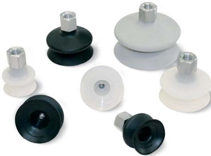
Die auf dieser Seite beschriebenen Sauggreifer werden, im Gegensatz zu den zuvor beschriebenen, mit einer hexagonalen Halterung aus Aluminium vulkanisiert. Dieser verfügt über einen Gewindeanschluss mit Außen- oder Innengewinde, der mit einer Gewindebohrung M8 für das eventuelle Einsetzen eines Bolzens mit kalibrierter Bohrung versehen ist (siehe S. 1.118).
