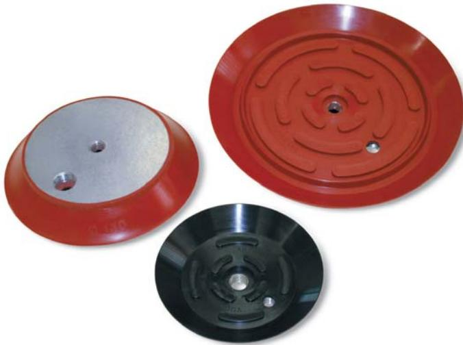
Diese Sauggreiferserie wurden für das Anheben und Bewegen großer Lasten entwickelt, sowohl in horizontaler als auch in vertikaler Richtung. Sie werden auf einer Halterung aus Stahl vulkanisiert und sind mit zwei Gewindebohrungen versehen: einer zentralen für die Befestigung an der Automatik und einer seitlichen für den Vakuumschluss.
