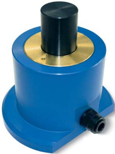
Diese Zentriersysteme wurden entwickelt, um ein schnelles Zentrieren der durch Aufspannplatten zu haltenden Last auf den Arbeitstischen der Maschinen zu ermöglichen. Der versenkbare Anschlagkolben wird beim Zurückkehren und beim Verweilen in seinem Sitz durch das Vakuum und beim Herausreten durch eine Feder aus rostfreiem Stahl betätigt.
