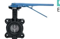
Valvola a farfalla tipo LUG PN 16, corpo in ghisa GGG40+vernice epossidica, guarnizione in EPDM.
