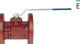
Valvola a sfera flangiata PN16, in ghisa, a passaggio Venturi scartamento secondo norme DIN 3202 F4.
