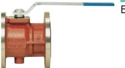
Valvola a sfera flangiata PN16 in ghisa, a passaggio totale da DN 25 a DN 200. Da DN 25 a DN 150 a scartamento secondo norme DIN 3202 F4 e DN 200 secondo norme DIN 3202 F5.
